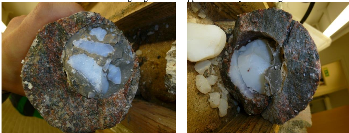
Figur 4. Vänster: Bild tagen på kärnan vid 3,3 m djup från överborrningen. Höger: bild vid 2,3 m längd. Både cement och silica sol ihop blandat återfinns. Kanalen som syns i cementet (ungefär vid klockan 9 i vänstra bilden och klockan 3 i högra) är den som transporterar vatten fram till öppningen på borrhålet vilket gör att flödet har kunnat mätas. Kanalen har dock kalcitutfällningar och i vissa delar av kärnan i omfattande mängd.
