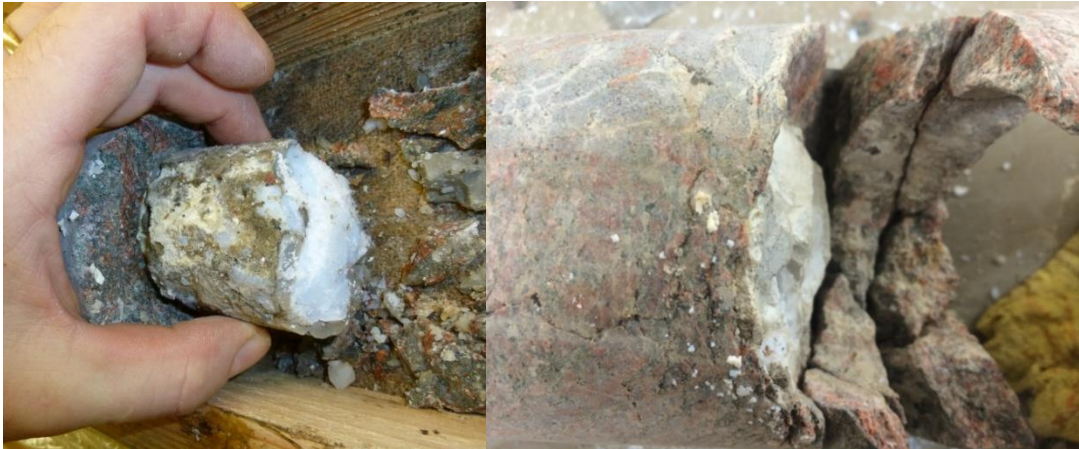
Figur 4. Vänster, injekteringspluggen med kanal som slutar. Höger, ihop pusslad borrhärna som visar sprickan som er upphov till kanalen i injekteringspluggen.
